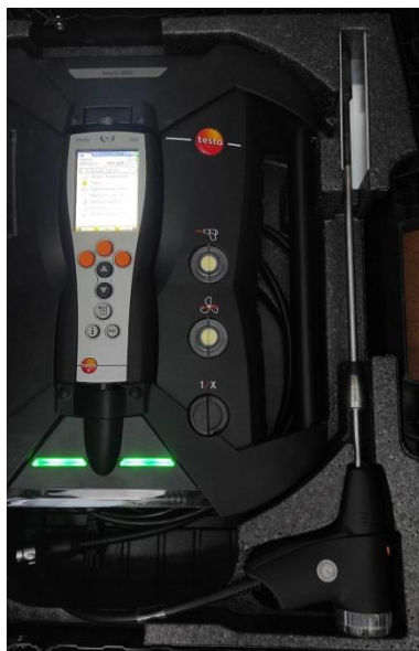
Obr. 2 Vybavenie na meranie plynných emisií
