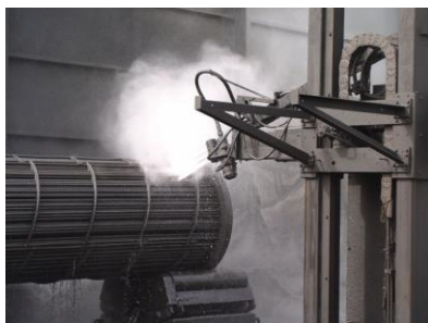
Obr. 1 Vonkajšie čistenie výmenníkov ropy
